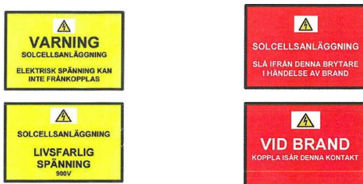
Figur 3. Exempel på skyltning. Till vänster - Allmän varning. Till höger – För brandkåren.
